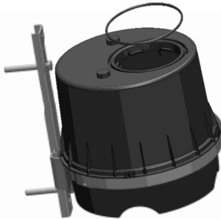
4. Auftriebssicherung mit den Löchern in die vorhandenen Fixiernoppen einlegen und mittels 2 x M8 Inbusschrauben an der Wandhalteschiene fixieren.
